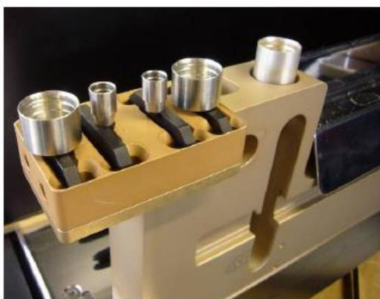
**Pinça CO-RE para canais de pipetagem de 1000 $\mu$ L (posição interna) e canais de pipetagem de 5mL (posições de fora): as garras em seu suporte**
