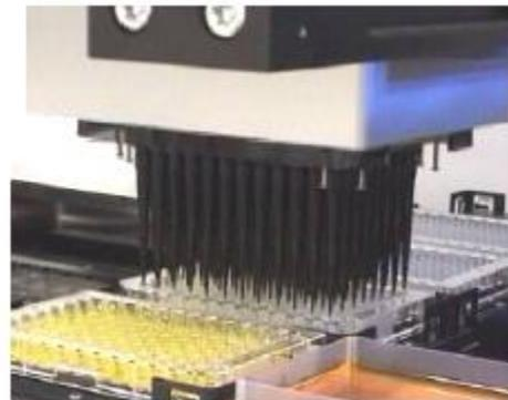
Ponteiros condutivos de 300µL estão disponíveis em racks de 96 ponteiros cada. Os racks das ponteiros são etiquetados com código de barras para serem identificados automaticamente durante o processo de carregamento. Os equipamentos da linha MICROLAB® STAR equipados com leitor de código de barras são capazes de checar o tipo de ponteira apropriado para o carregamento.
