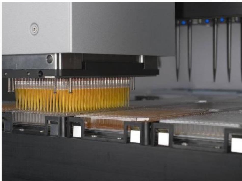
Ao contrário do cabeçote CO-RE de 96 sondas, este cabeçote é capaz de pegar uma coluna de ponteiros apenas com o Módulo de Elevação de Ponteiros.
