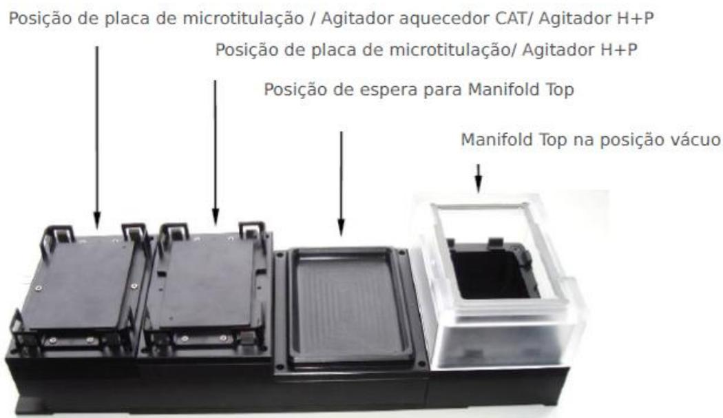
O carreador do sistema de vácuo BVS é montado na base de trabalho do equipamento. O manifold top pode ser manuseado tanto por um iSWAP ou Pinça CO-RE. Se trabalhando com iSWAP, quatro trilhos próximos ao carreador BVS deve estar vazio, normalmente do lado direito.
