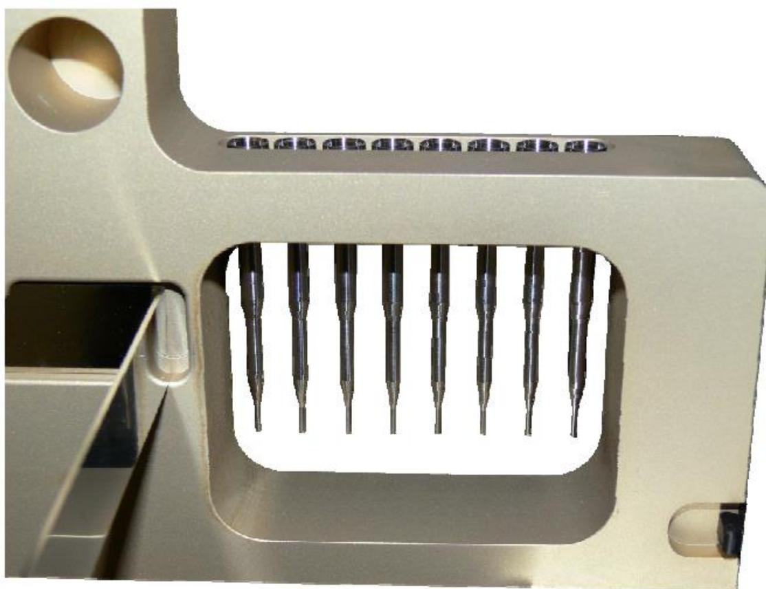
4. O procedimento continua com a checagem do aperto dos canais de pipetagem. O braço de pipetagem se moverá para o lado direito para pegar as ponteiros metálicos de verificação.
