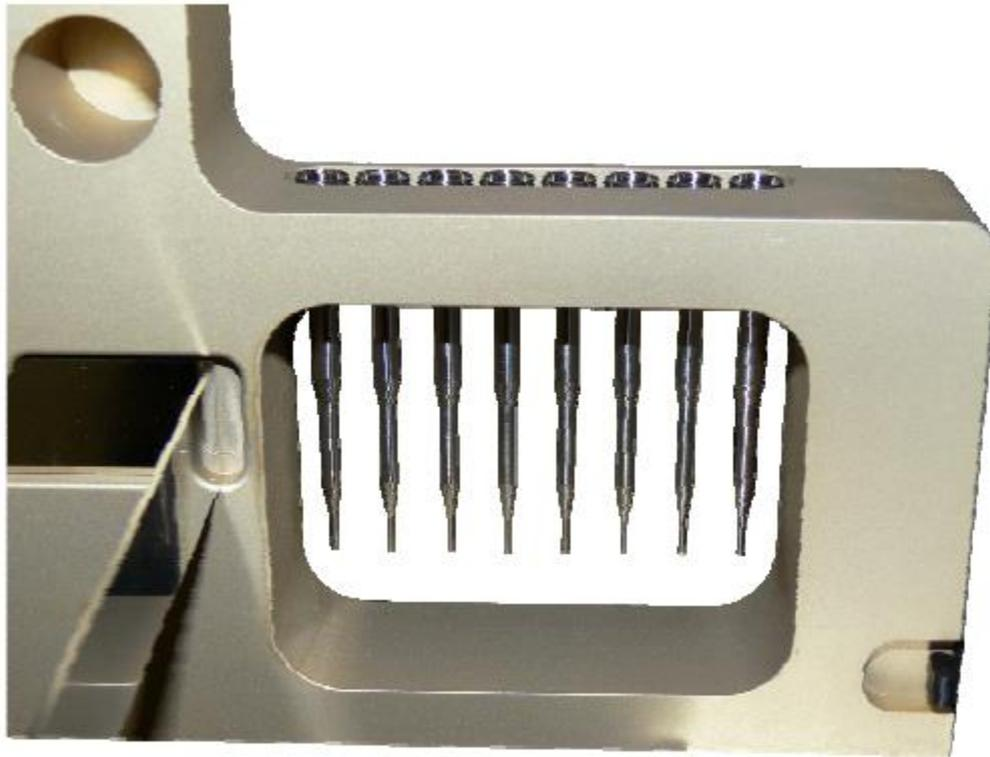
7. O procedimento continua com a checagem do aperto dos canais de pipetagem. O braço pipetador se moverá para o lado direito para pegar as ponteiros metálicos de verificação
