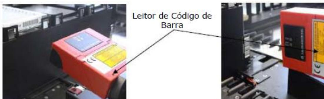
A unidade de autoload incluindo o leitor de código de barras faz a leitura na horizontal das placas e vertical dos carreadores e tubos.
