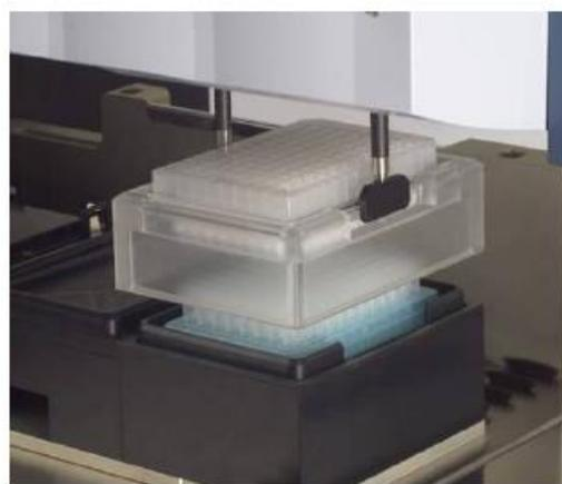
**Pinça CO-RE para canais de pipetagem de 1000 $\mu$ L**
