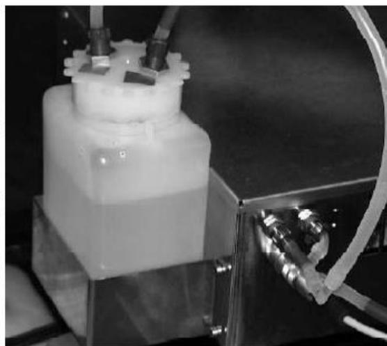
Reservatório de solução para troca de calor
