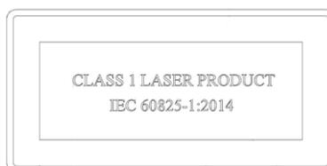
A seguinte etiqueta aparece acima das aberturas do laser localizadas no interior da caixa óptica dentro do LABSCAN 3D.
